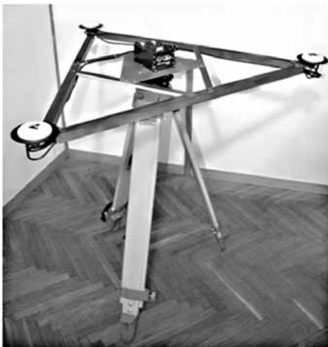
Рис. 4. Комплекс в сборе с тремя СНС антеннами
