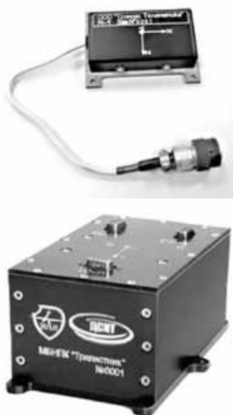
Рис. 3. Малогабаритная интегрированная система ориентации и навигации и ее внешний магнитный компас
